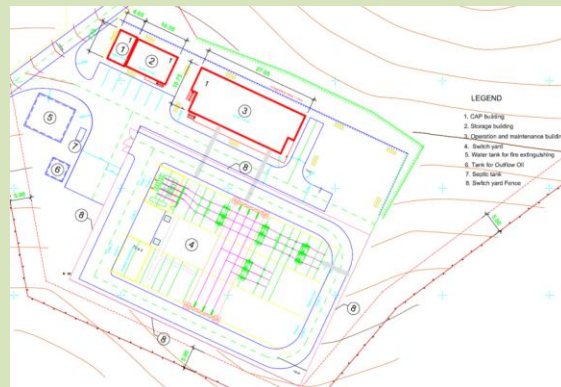
Фотоволтаична централа: ОРУ 110kV
