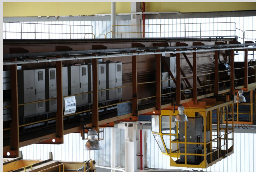
Главна греда и кабина на 200-тонен кран
